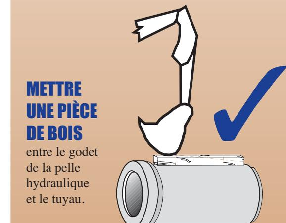
**METTRE UNE PIÈCE DE BOIS** entre le godet de la pelle hydraulique et le tuyau.
