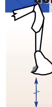
**NE PAS VIDER** le contenu du godet de la pelle à une hauteur excessive du fond de la tranchée.
