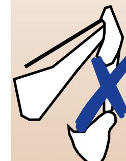
**NE JAMAIS APPUYER DIRECTEMENT** le godet de la pelle hydraulique sur le tuyau.
